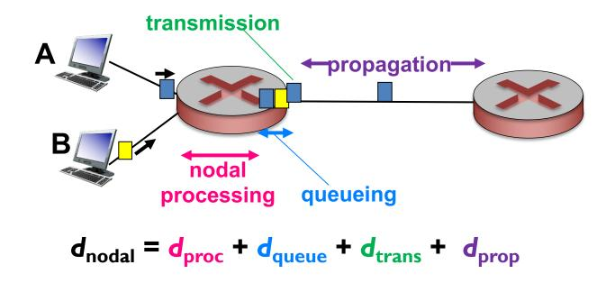
$d_{\text{trans}}$ : transmission delay  $d_{\text{prop}}$ : propagation delay
